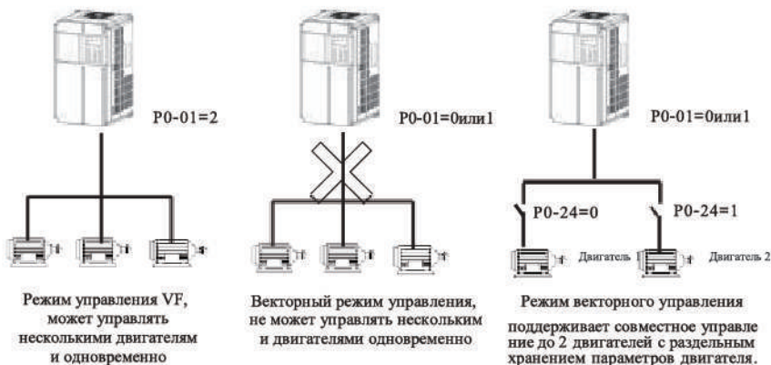
Рис. 4-29. Переключение нескольких двигателей
